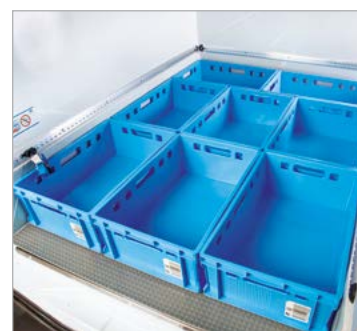
Heckeneinsicht Grundbeladung E2-Kisten
